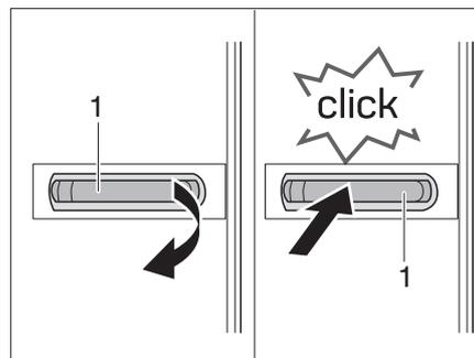
Bild 116 Kühlschranktür öffnen/schließen
