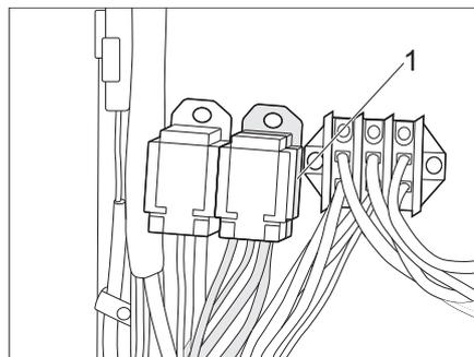
Bild 85 Sicherung der Zuziehilfe innerhalb des Küchenblocks
