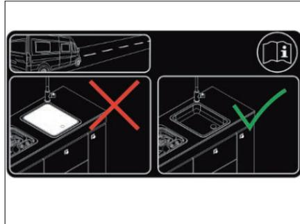
Bild 2 Sicherheitsaufkleber Spülenabdeckung
