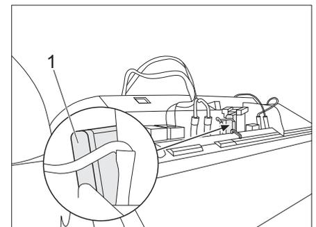
Bild 90 Sicherung Umschaltanlage DuoControl/ Panel CP plus
