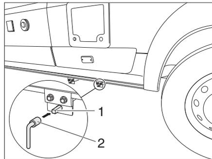
Bild 127 Bedienung Abwasserhahn
