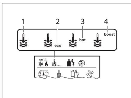
Bild 100 Einstellmöglichkeiten Warmwasser
