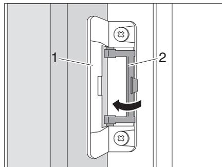
Bild 119 Lüftungsstellung arretieren
