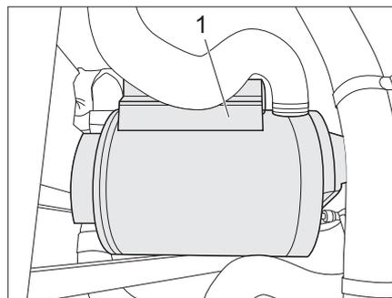
Bild 89 Abdeckung Heizung
