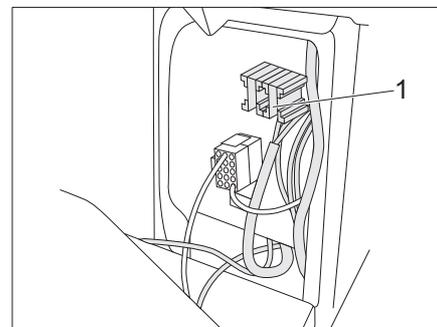
Bild 86 Sicherung der Zuziehilfe in der B-Säule
