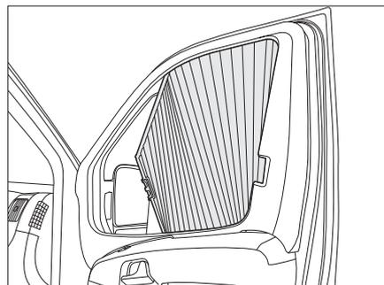
Bild 17 faltverdarkung für das Fahrer-/Beifahrerfenster
