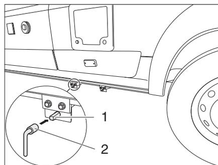
Bild 125 Bedienung Frischwasserhahn
